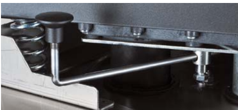
Luchtstroom omkeerhendel voor automatische filterreiniging
