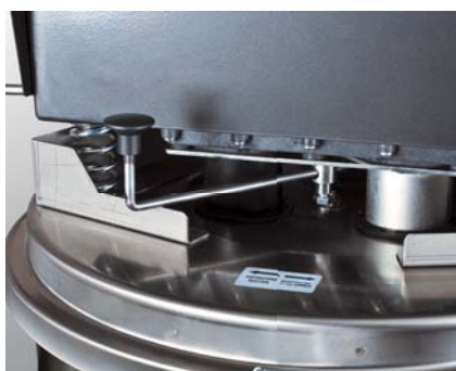
Luchtstroom omkeerhendel voor automatische filterreiniging
