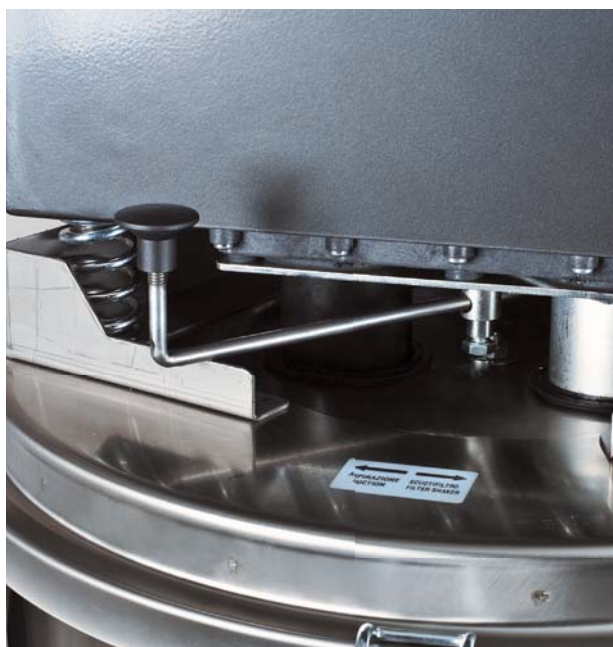
Luchtstroom omkeerhendel voor automatische filterreiniging
